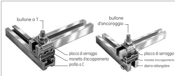
Connessioni tra sbarre rettangolari verticali e orizzontali
